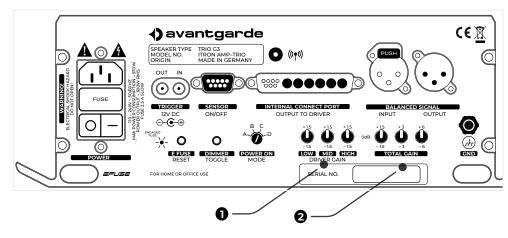
$\odot$ LOW MID HIGH Die 3 x DRIVER GAIN-Schalter **1** ermöglichen die Einstellung einer individuellen Lautstärkekorrektur der 3 Hörner in -1,5 dB, O dB (= linear) und +1.5 dB Schritten.
