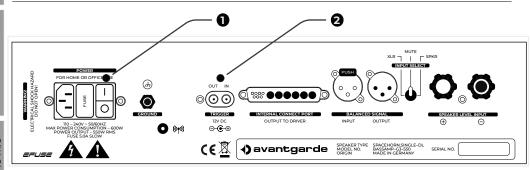
1 Der Netzschalter **1** hat eine "O" OFF-Position und eine "1" ON-Position. Zum Betrieb auf die ON-Position schalten. Wenn das SPACEHORN längere Zeit nicht benutzt wird, schalten Sie das System in die "O" OFF-Stellung.
