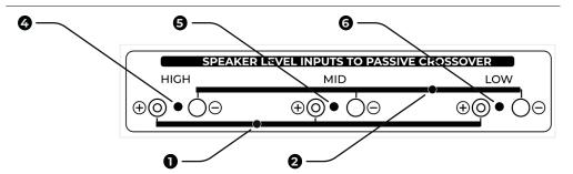
Hoch-①, Mittel- ③ und Tieftöner ⑥ haben separate Lautsprecheranschlüsse. In der Standardkonfiguration sind diese Anschlüsse mit 2 x OFC 3-fachBrücken ①&② miteinander verbunden. Eine Brücke verbindet alle "+" Anschlüsse ① miteinander, die andere ② alle "-" Anschlüsse.
