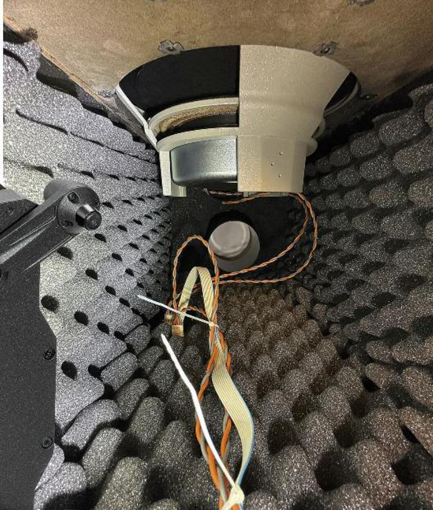
Oben: Die beiden Tieftöner der Duo GT arbeiten, anders als beim Vorgängermodell, in einem Bassreflexgehäuse. In Verbindung mit den neuen Basstreibern resultiert dies in einer gegenüber der Duo XD fast zweimal so großen dynamischen Aussteuerungsreserve
