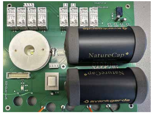
Wird die teilaktive Version der Uno SD gewählt, sorgt eine mit hochwertigen Teilen wie „Nature Caps“ (r.) besetzte Passivweiche für Präzision.
