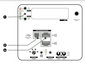
Die Basswiedergabe des Lautsprechers wird durch den Raum und die Position des Lautsprechers beeinflusst. Je nach Aufstellung kann so die Basswiedergabe des Lautsprechers verstärkt oder abgeschwächt werden. Um diese Effekte zu kompensieren, muss als erster Schritt die Gesamt-Basslautstärke angepasst werden.
