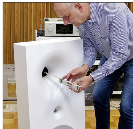
Die Tiefe des Schalltrichters für den Mitteltöner beträgt stattliche 21 Zentimeter.
