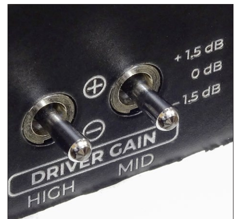
Der Pegel des Mittel- und Hochtöners lässt sich im Bereich von +/- 1,5 Dezibel anpassen.
