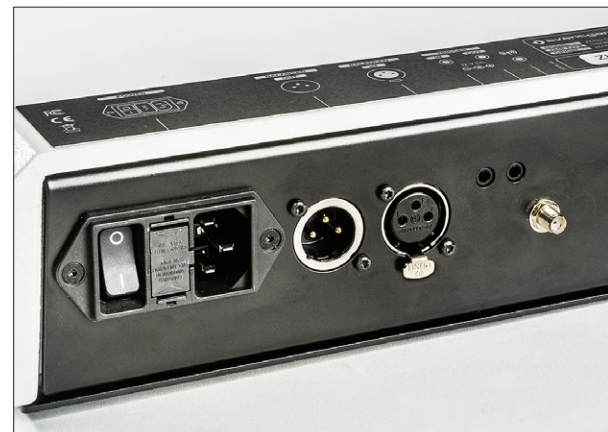
Hauptschalter, XLR-Ein- und -Ausgang mit Durchschleiffunktion, 12-Volt-Trigger-Buchsen.
