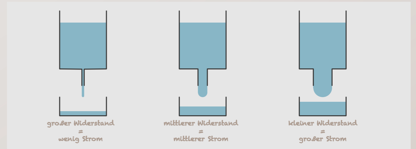
Wasserbehälter mit identischem Wasserstand, bzw. Druck (= Spannung).
