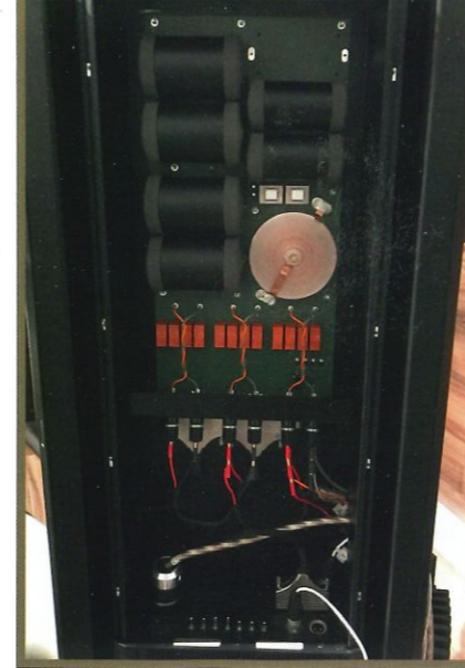
Im seitlich platzierten Modul der Trio G3 befinden sich die „NatureCap“ Kondensatoren
